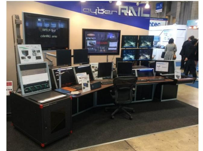
「cyber RAIL α」はデザイン性はそのままに操作部(テーブル面)もモジュール化することで10U EIAラックマウント機構を標準装備し、袖部はヘッドセットやインカム等の取付にも対応可能です。
