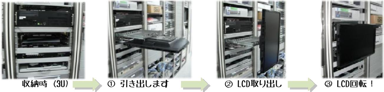
収納時 (3U) → ① 引き出します → ② LCD取り出し → ③ LCD回転！
