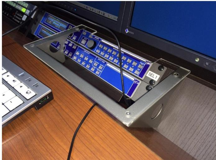
写真のように落とし込みされたEIAラックマウント部をガード。EIAマウント部の機材のスイッチ部分に触れないように、またデザイン性も考慮致しました。アクリルはクリアを採用し、高い視認性を確保しています。
